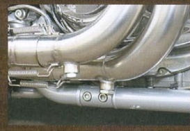
コレにより、排気の空燃比を調節できることできる。H-D用マフラーではなかなかないギミックだ
