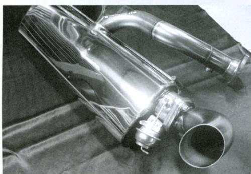
←取付前の音量可変マフラー。写真手前に見えるのが作動用のソレノイドバルブ。内部でバタフライが回転して排気の通路を切り替える。
