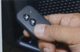
弁の開閉(音の切り替え)を行なうリモコン。乗ったままスイッチを操作するだけで、音が変わるもの面白い。全開時など排圧がかかっている状態では作動しない。エンジン始動時には自動的にサイレンサー仕様に戻る。
