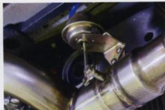
テール部分がこのマフラー最大のポイント。パイプのレイアウトに注目して欲しいのだが、サイレンサーに入っていくのは左側のみ。サイレンサーの内側はパイプがUターンするようなレイアウトになっているため、高い消音効果を発揮。右側の入り口にはアクチュエーターが装着され、パイプ内側の弁の開閉を行っている。この弁が開くと、リアサイレンサーを通らない迫力のレーシングサウンドとなる。バンパー出しを見越して薄く作られているのもポイント。いい音にはセンターのサブサイレンサーの役割も大きいのだと。
